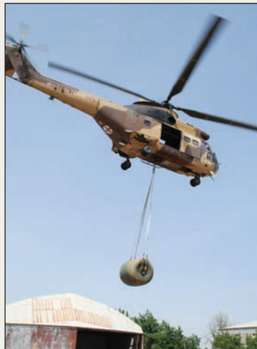
Quelques moyens du SEA : camion-citerne, fût souple transporté sous élingue et bac souple de campagne pour kérosène.
