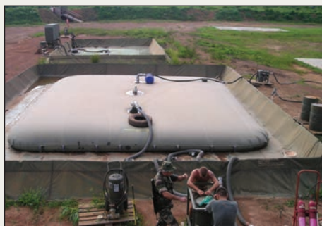
Quelques moyens du SEA : camion-citerne, fût souple transporté sous élingue et bac souple de campagne pour kérosène.
